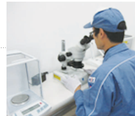
带自动捕捉异物的光学显微镜
