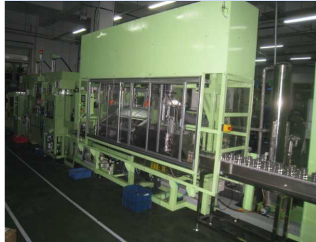
转子 毛刷去毛刺·超声波清洗·浸油机
